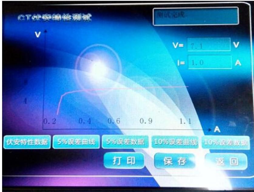
图 7 打印:用手指点击 **打印** 选项，打印机将打印当前的伏安特性曲线和伏安特性数据。
