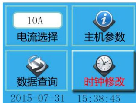
在上图中，按**循环**键可将光标在各个日期数据之间移动，按**选择**键减小数据，按**启动**键增加数据。
