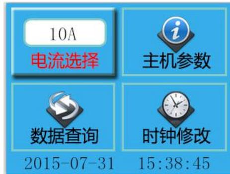
按**循环**键光标可在**电流选择**、**数据查询**、**主机参数**、**时间修改**等包含的选项之间移动，按**选择**键可对上述六项主菜单包含的选项循环选择。
