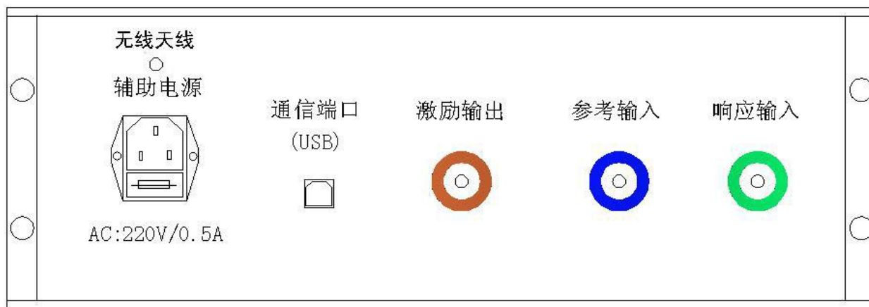
变压器绕组变形测试仪后面板图（图 2）
