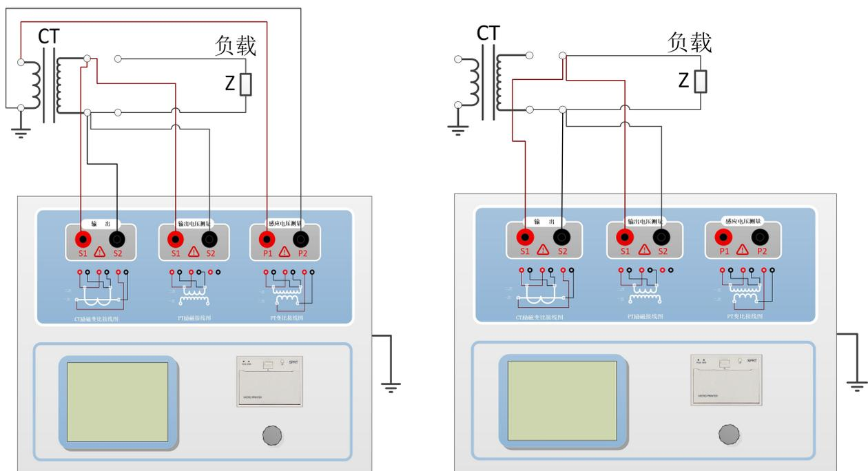
图 2.1 CT 直阻、励磁、变比试验接线方式
